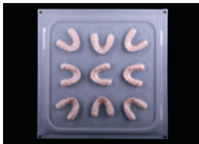
9 tiefgezogene Rohlinge in einem Tiefziehprozess: Biolon für Vacformat V9
