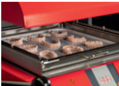
9 tiefgezogene Rohlinge in einem Tiefziehprozess: Biolon für Vacformat V9
